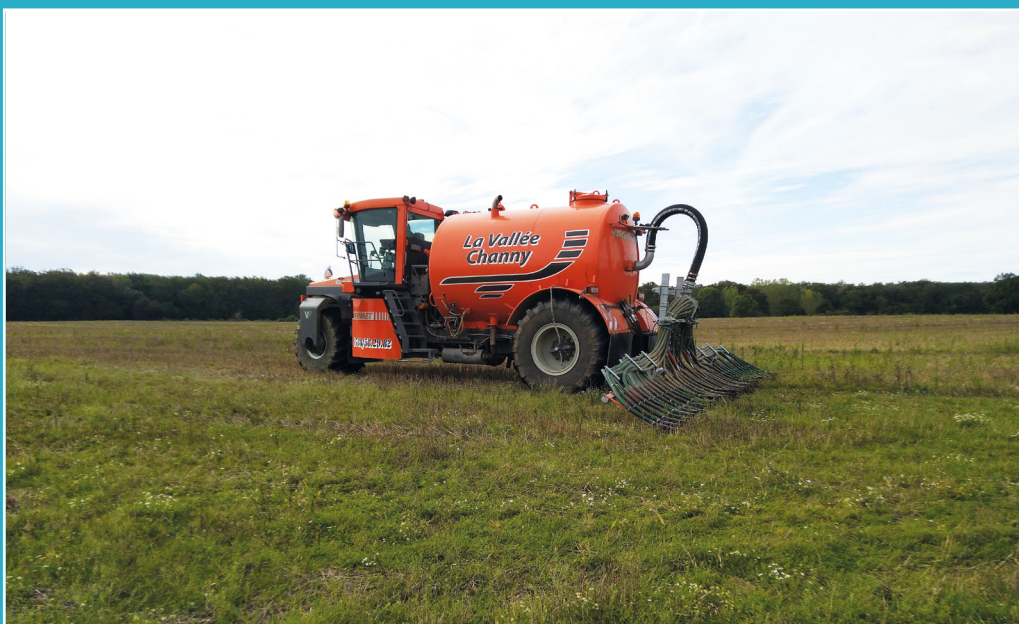
Epandage de boues d'épuration chaulées (source Sede)
