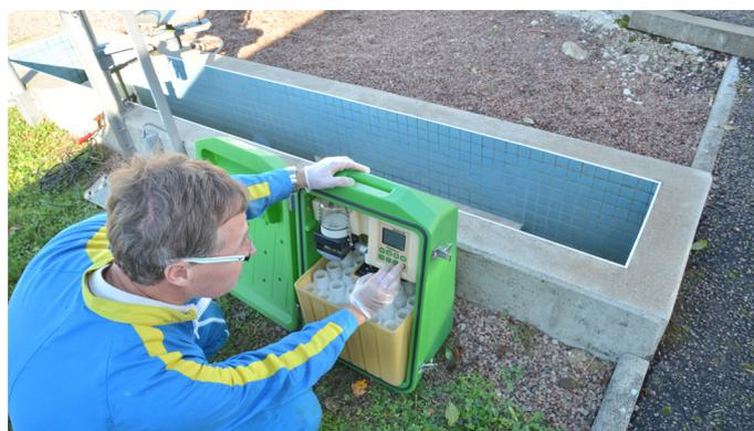
Installation d'une mesure en sortie de station d'épuration - source SDE
